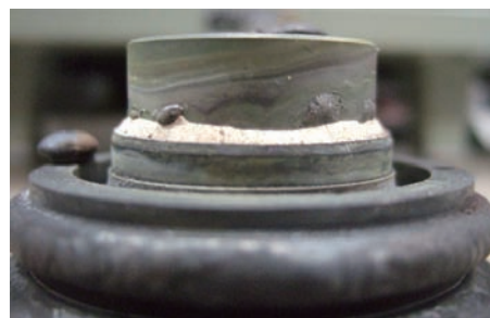
図7 試験後の外部絶縁沿面部周辺の写真
