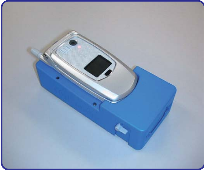
MCC を使用した携帯電話充電試作機 (栗田工業)
