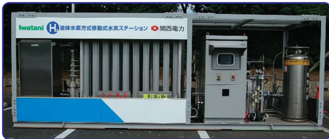
液体水素方式移動水素ステーション（岩谷産業、関西電力）
