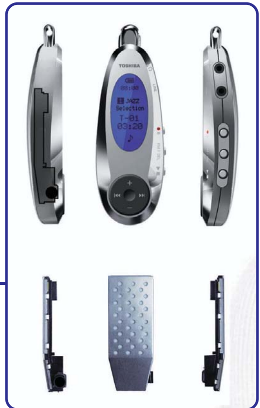
マイクロ燃料電池とそれを搭載した オーディオプレイヤー (東芝)
