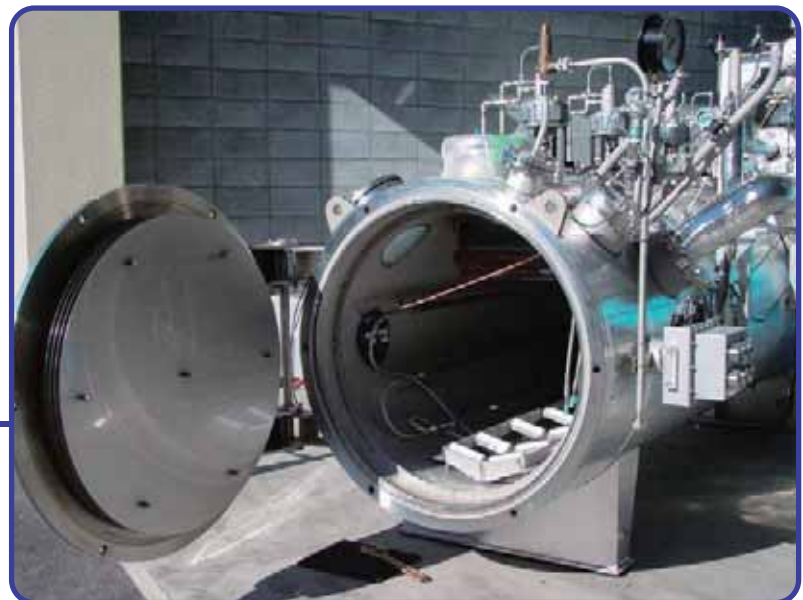
ガス透過試験チャンバー (日本自動車研究所)
