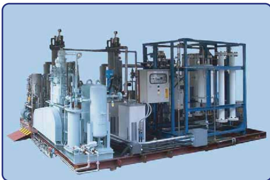
都市ガスを原料とする 水素製造装置 (バブコック日立)
