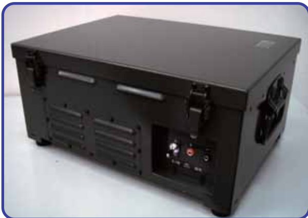
30W 級ポータブル燃料電池 (日本製鋼所、ニッセイ)
