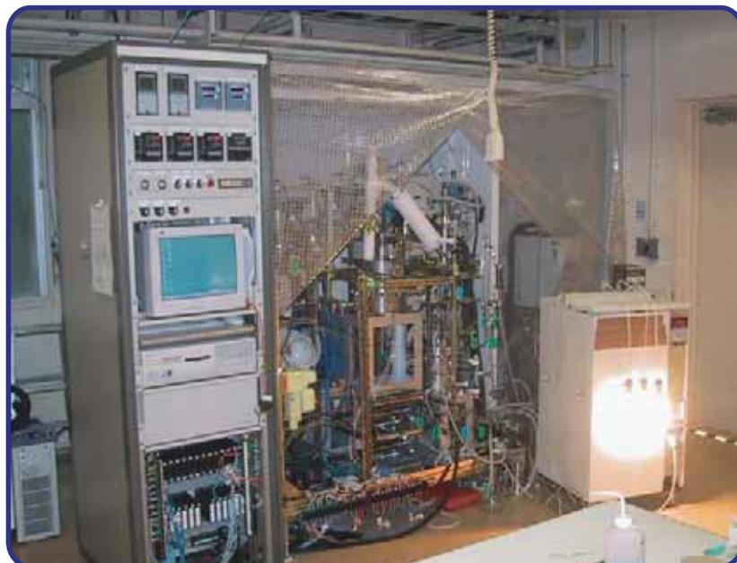
シクロヘキサン・デカリン高速水素発生装置(実証機)1-3kW定置燃料電池用仕様(北海道大学市川教授)
